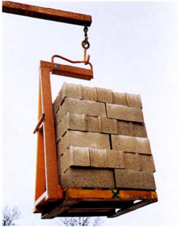
GRIFFE ÉQUILBRÉE LÉGÈRE ÉQUIPÉE D'UN ANNEAU À 2 POSITIONS.
