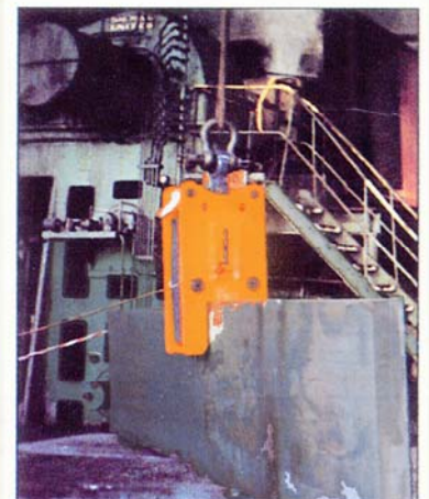
Pince télécommandée à distance stable à une température jusqu'à 1320° C pour des tôles brûlantes IPSL
